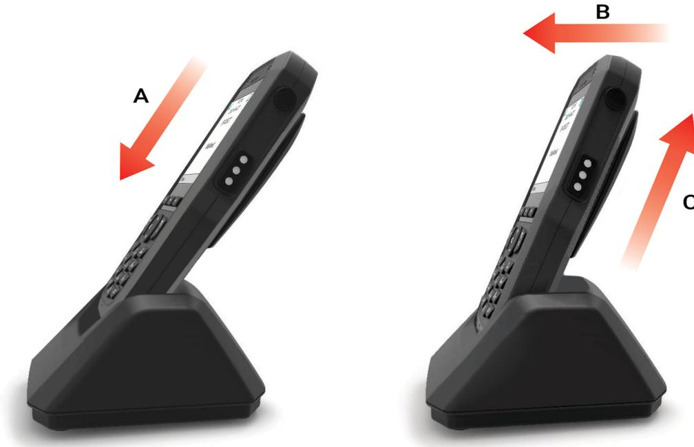
**Figura 4: Ejemplo de inserción y extracción del teléfono del cargador de escritorio**
